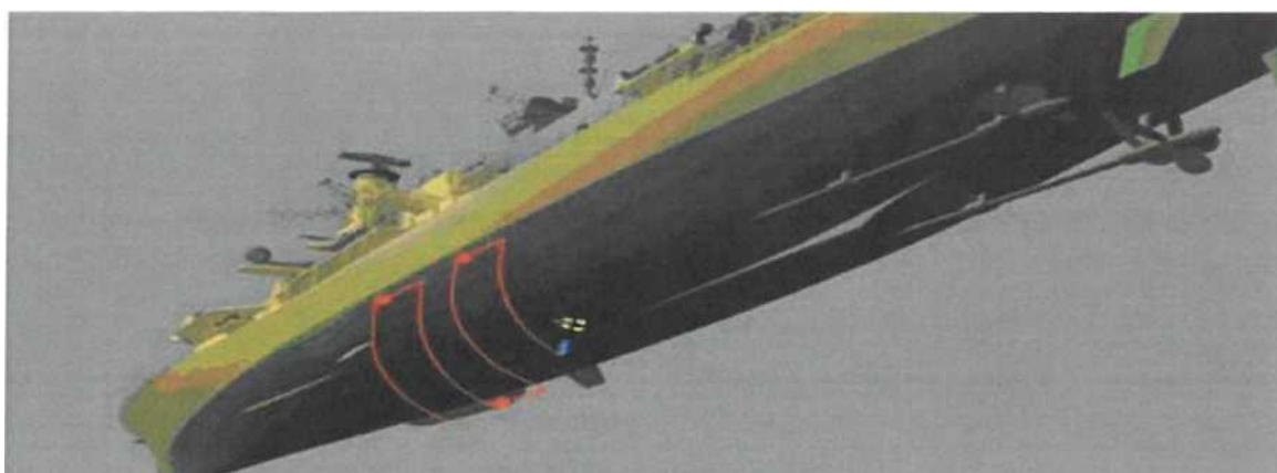
Рис. 4. Подводная часть корпуса и винто-рулевая группа корабля
